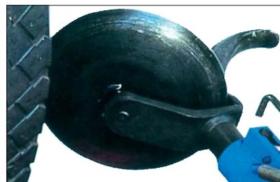
Отжимная тарелка оснащена специальной поворотной системой, которая увеличивает силу отжима и обеспечивает постоянное оптимальное положение тарелки относительно обода.
