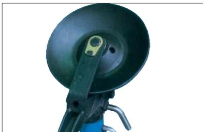
Отжимная тарелка оснащена специальной поворотной системой (патент), которая увеличивает силу отжима и обеспечивает постоянное оптимальное положение тарелки относительно обода
