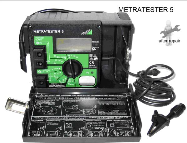
Das Prüfgerät ist zum Prüfen und Messen an instandgesetzten oder geänderten elektrischen Geräten nach DIN VDE 0701 oder DIN VDE 0702 bestimmt. Gemäß diesen Vorschriften müssen nach einer Instandsetzung oder Änderung elektrischer Geräte der Schutzleiterwiderstand, der Isolationswiderstand, der Ersatz-Ableitstrom und bei Datenverarbeitungseinrichtungen und Büromaschinen die Spannungsfreiheit berührbarer leitfähiger Teile gemessen werden.
